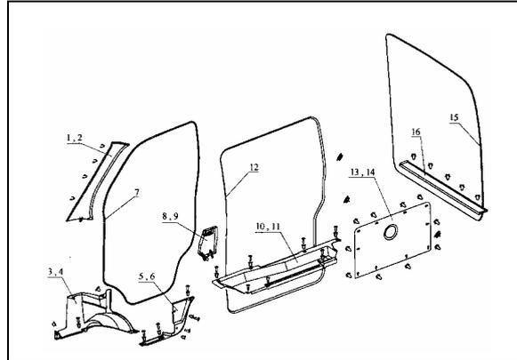
1、 2 A pillar inner trim upper 3、 4 A pillar inner trim lower 5、 6 Front door sill garnish 7、 Front door wetherstrip 8、 9 Front retractor cover 10、 11 Slide door sill garnish 12、 Slide door wetherstrip 13、 14 Rear side panel inner cover 15、 Tail door wetherstrip 16、 Tail door sill garnish
