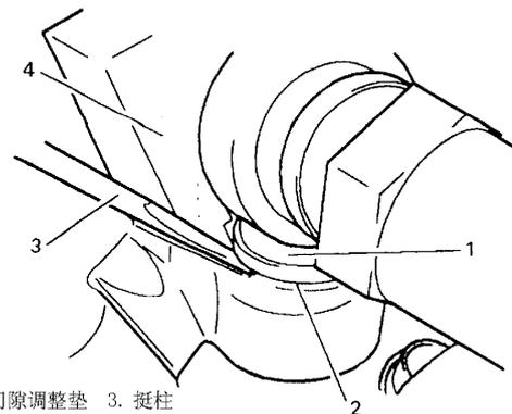
1. 气门间隙调整垫 3. 挺柱
