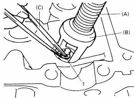
1. 气门卡簧 1. Valve circlip
